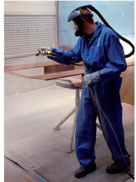
Bis zu sieben Lackschichten werden auf die Hölzer aufgebracht.
