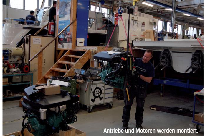
Antriebe und Motoren werden montiert.
