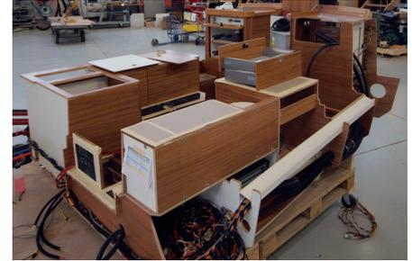
Der Innenausbau wird vor dem Einbau zusammgebaut und dann als Baugruppe montiert.
