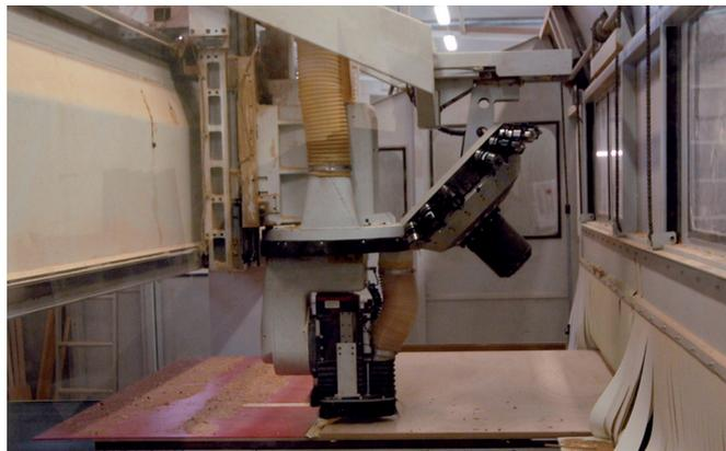
Die Bauteile des Innenausbau werden mit CNC-Maschinen millimetergenau gefräst und zugeschnitten.
