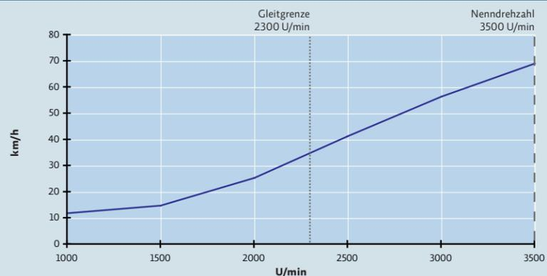
Leerlauf: 700 U/min, Höchstgeschwindigkeit: 69,1 km/h bei 3500 U/min.
