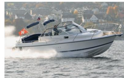
Ce modèle est équipé d'une coque à étages lui conférant d'excellentes propriétés de navigation pour une consommation économique. Le Nimbus 31 Nova S propose une navigation très tranquille et précise. Le procédé de construction massif et solide de la coque renforce les bonnes propriétés de navigation du bateau. Le propulseur d'étrave (en option) est particulièrement pratique lors de manœuvres serrées dans un port.
