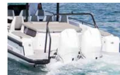
Die Doppelmotorisierung ist ein Must. Das Testboot war mit zwei weissen Mercury Verado V8-Motoren ausgestattet, die je 300 PS leisten. Diese Konfiguration ist in der Schweiz typengeprüft, zur Einhaltung der Lärmvorgaben wurde der Rumpf mit einer speziellen, dämpfenden Farbe behandelt. Für den Bodensee ist eine Motorisierung mit zwei Mal 150 PS möglich.
