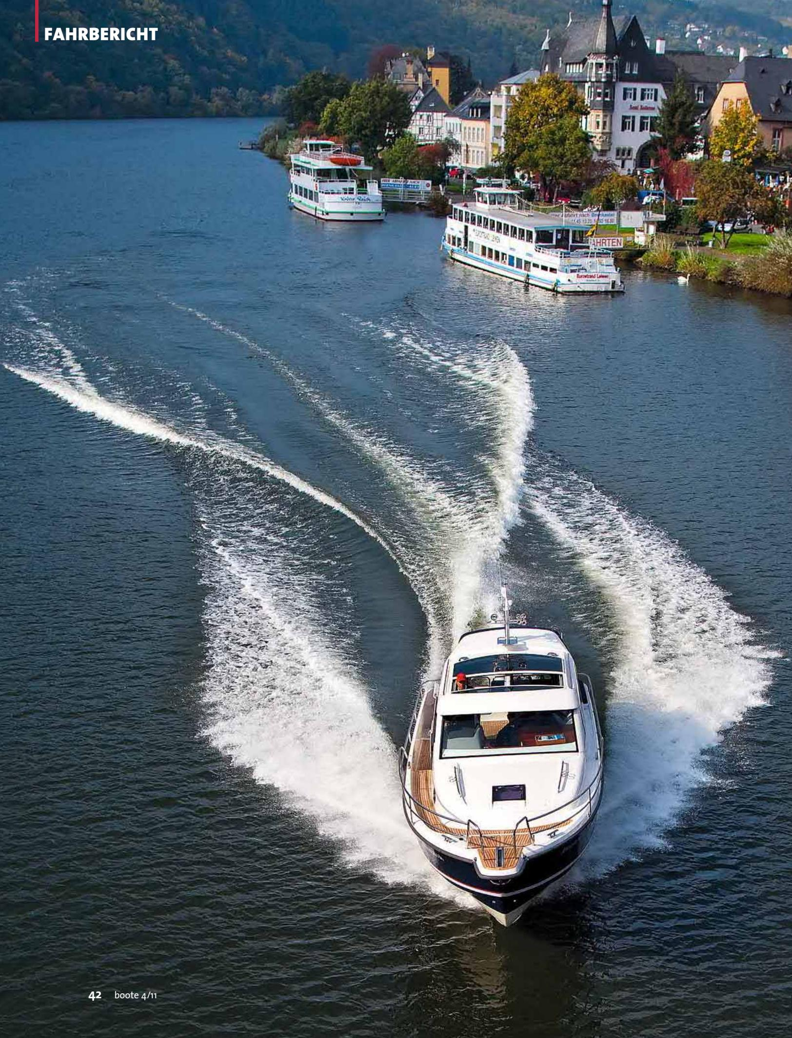
**Fahren Wirtschaftlich ist man mit der Nimbus um die 2800/min mit knapp 19 kn unterwegs. In die optimale Lage bringt man das Testboot mit Trimmklappen, die Aufpreis kosten.**
