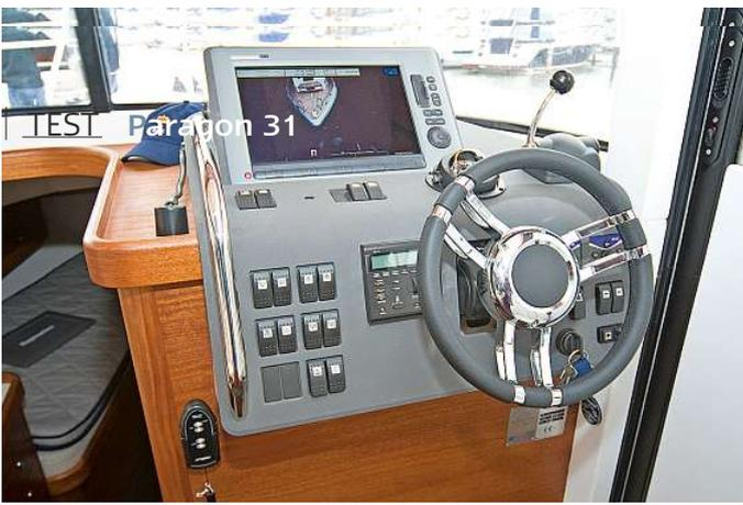
Wie aus einem Guss: Übersichtlicher Steuerstand mit Plotter
