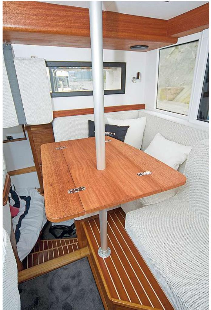
Gut gelöst: Bei Nichtgebrauch wird der variable Tisch an der Säule nach oben geschoben und mit einer Knebelschraube sicher fixiert
