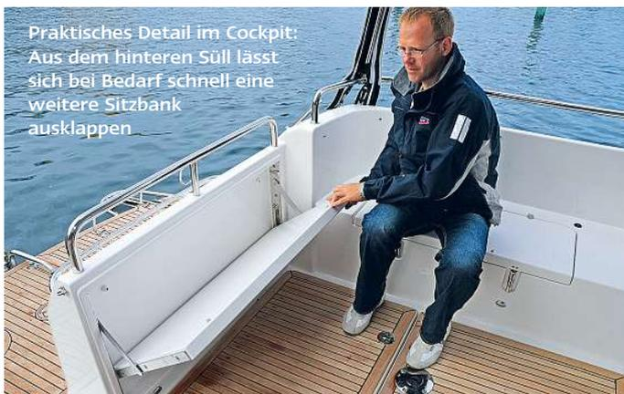
Praktisches Detail im Cockpit: Aus dem hinteren Sill lässt sich bei Bedarf schnell eine weitere Sitzbank ausklappen
