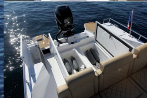
Le plancher dissimule des coffres de rangements. Pare-battage et matériel de sécurité y seront bien calés.
